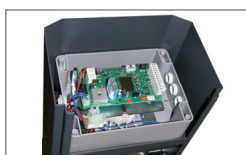
Электронный блок управления расположен на верхней части картера
