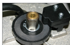
Механическая двухдисковая муфта (только для SATURN OIL)
