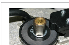
Механическая двухдисковая муфта в масляной ванне
