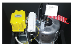
Механический концевой выключатель с рычагом
