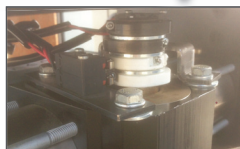
Механические или регулируемые электронные концевые выключатели
