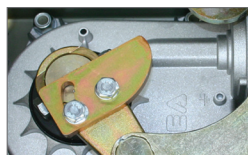
Регулируемый механический стопор при открытии и закрытии
