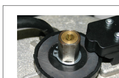
Механическая двухдисковая муфта
